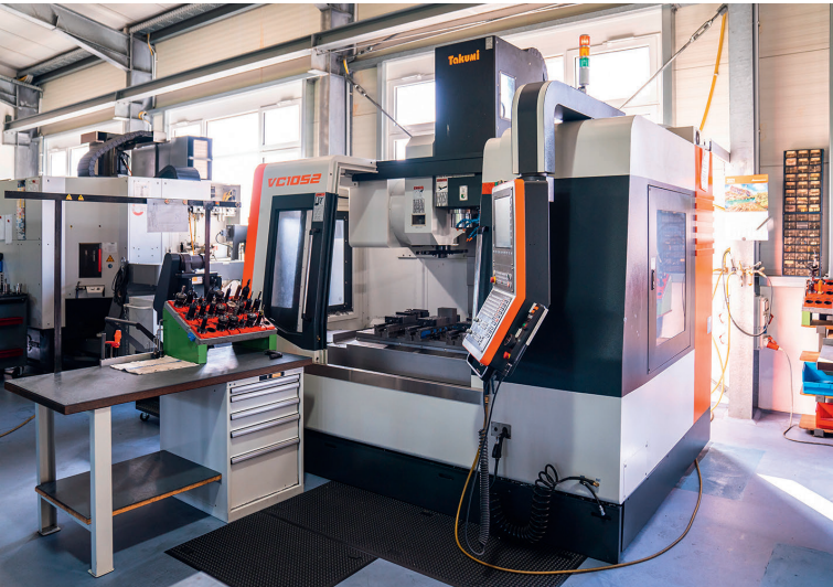
2 Das Bearbeitungszentrum VC 1052 ist speziell für die Einzelteilfertigung ausgelegt, unter anderem für den Werkzeug- und Formenbau, wo die Devise gilt: gleich richtig, gleich perfekt © Takumi
